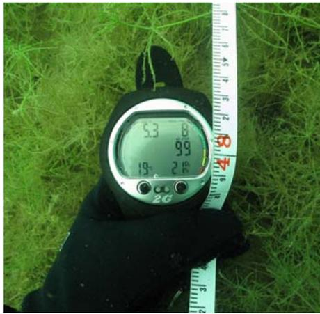
**Foto 2:** Fotodokumentation der Wassertiefe und des Abstandes von der Uferlinie mittels Maßband und Tauchcomputer (Juli 2012).
